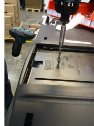
035182 Skruv Savo Soul till fjäder Bits NV4, Makita, Moment 8
