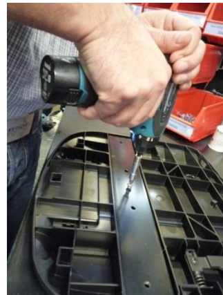
035180 Skruv 6x16, förzinkad Bits PZ2, Makita, Moment 18
